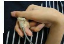
スプリット素材もスイッチを固定するのに適しているよ
